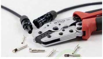
introduciremos en el interior del cuerpo de plástico correspondiente quedando asegurado y enroscado para disponer de estanqueidad y protección.
