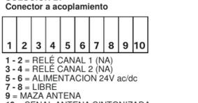
**CAUIDADO:** si la alimentación de la unidad receptora se efectua en corriente alterna (Vac), la alimentación debe ser conseguida por medio de un transformador de aislamiento (de seguridad, tensiones SELV) que haya una potencia limitada o al menos una protección contra el cortocircuito.
