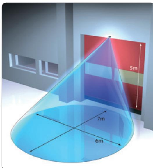
Área de detección cuando el sensor está montado a una altura de 7 m con la carcasa colocada a un ángulo de  $45^\circ$
